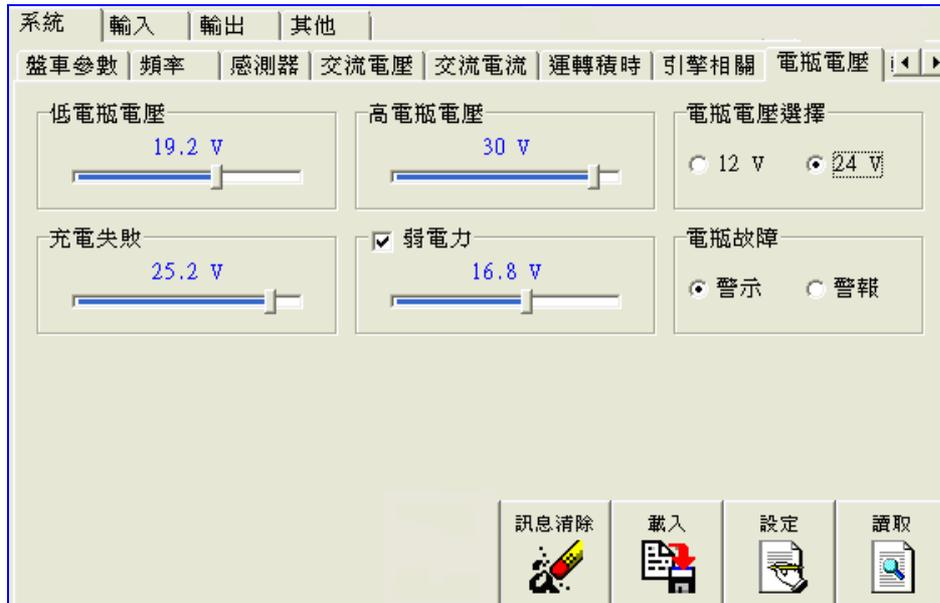
圖 28 電瓶電壓參數設定
