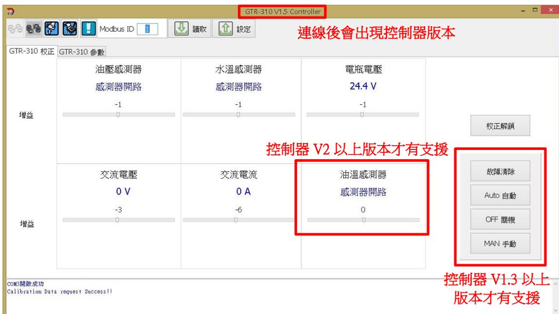
12.3 軟體設定參數畫面：包括Modbus通訊ID位址、交流電壓保護致能、交流高壓電、交流低壓電、交流電流保護致能、交流過電流以及通訊速率。
