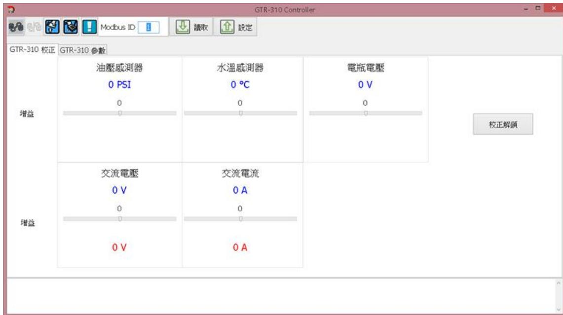
12.2 軟體(連線後)校正參數畫面：包括油壓顯示值、水溫顯示值、電瓶電壓顯示值、交流電壓顯示值、交流電流顯示值以及油溫顯示值。
